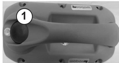
IVURplus D durch Drücken des Schalters (1) einschalten. Der Innenvibrator läuft an.
