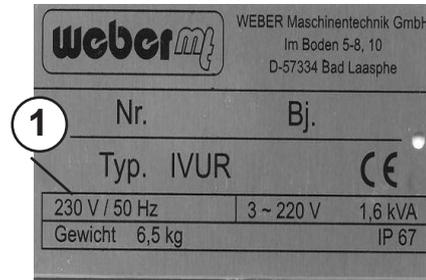
Der Anschluss erfolgt an 230 Volt/50 Hz Wechselstrom..
