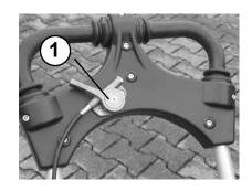
Fahrgeschwindigkeit und Fahrtrichtung mit Handgriff (1) regeln.
