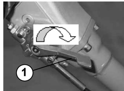
Fahrgeschwindigkeit und Fahrtrichtung mit Handgriff (1) regeln.
