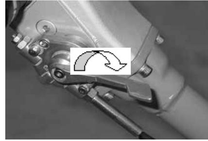
Handgriff (1) des Reversierstarters (2) langsam anziehen, bis Widerstand spürbar wird.
