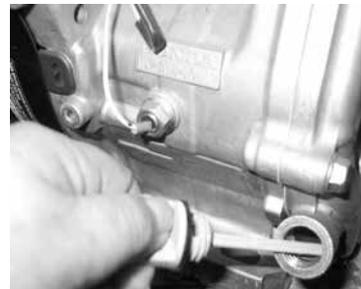
Korrekter Ölstand zwischen min. und max. Markierung.
