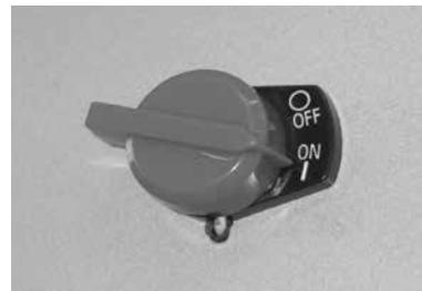
Hebel des Kraftstoffhahns (1) nach rechts schieben.
