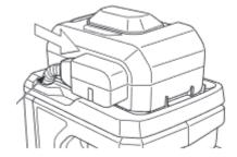
▶ Die Schutzkappe des Akkusteckers entfernen und das Netzkabel einstecken.
