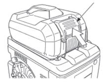
▶ Den Akku-Befestigungshebel nach oben drücken und den Akkupack verriegeln.
