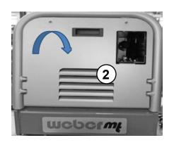
Verschlußdeckel (1) des Ölfilters öffnen.
