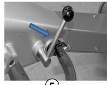
Zündschlüssel (1) einstecken und auf Stellung 1 drehen. Zündschlüssel (1) auf Stellung 2 drehen. Sobald der Motor läuft, Zündschlüssel losslassen
