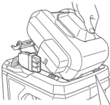
▶ Sicherstellen, dass sich kein Schmutz auf dem Akkuhalter befindet.
