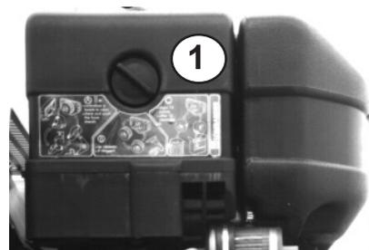
Luftfiltereinsatz (1) aus dem Luftfiltergehäuse entnehmen.
