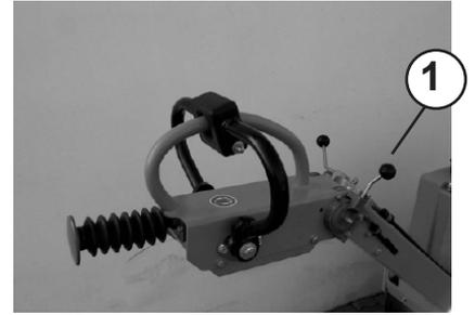
Feststellbremshebel (1) in senkrechte Stellung schieben (lösen).
