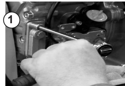
Ölfilter (1) durch ein neues Element ersetzen.
