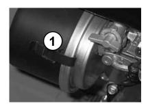
Luftfiltereinsatz (1) aus dem Luftfiltergehäuse entnehmen.
