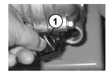
Ölablaßschraube (1) entfernen und Öl ablassen.
