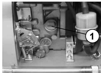
Ölablassrohr (1) am Ablassventil des Motors anschrauben und Öl ablassen.
