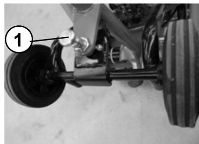
Fahrkarre (1) unter die Bodenplatte (2) schwenken.
