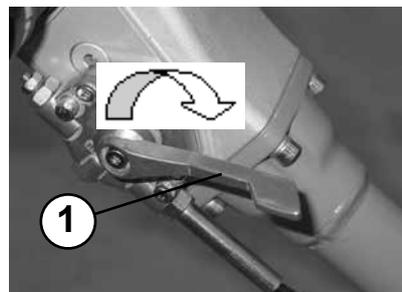
Fahrgeschwindigkeit und Fahrtrichtung mit Handgriff (1) regeln.
