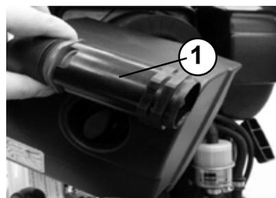
Luftfiltereinsatz (1) aus dem Luftfiltergehäuse entnehmen.
