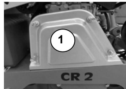
Keilriemen (1) auf Risse, ausgebrochene Flanken sowie Verschleiss prüfen.
