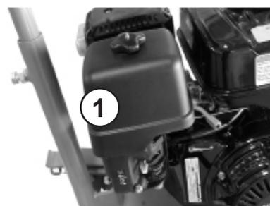
Luftfiltereinsatz (1) aus dem Luftfiltergehäuse entnehmen. Luftfiltereinsatz gem. Vorschrift des Motorenherstellers reinigen, bei Beschädigung oder extremer Verschmutzung austauschen.
