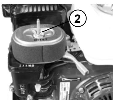
► Den Luftfiltereinsatz entnehmen. Dazu die Flügelmutter (2) lösen.
