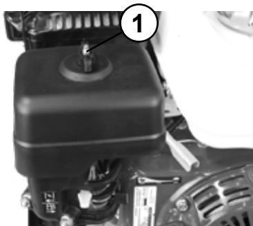
► Den Luftfilterdeckel öffnen. Dazu die Flügelmutter (1) lösen.
