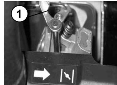
Handgriff (1) des Reversierstarters (2) langsam anziehen, bis Widerstand spürbar wird.
