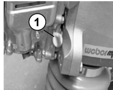
Korrekter Ölstand zwischen min. und max. Markierung.
