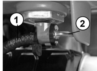
Kraftstoffhahn einschl. Kraftstofffilter (1) aus dem Kraftstofftank herausschrauben.
