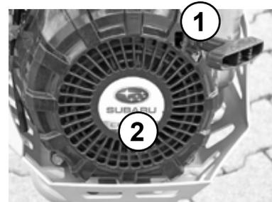
Handgriff (1) in Ausgangsstellung zurück gleiten lassen und dann kräftig, mit beiden Händen, vollständig durchziehen.
