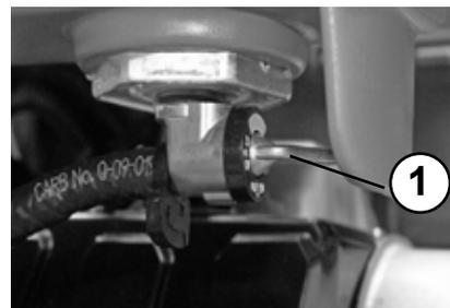
Zum Abstellen des Motors den Gashebel über die Raststellung Leerlauf nach hinten drücken
