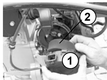
Luftfiltereinsatz (2) und Luftfiltervlies aus dem Luftfiltergehäuse bzw. Luftfilterdeckel entnehmen. Luftfiltereinsatz und Luftfiltervlies gem. Vorschrift des Motorenherstellers reinigen, bei Beschädigung oder extremer Verschmutzung austauschen.
