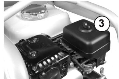
Luftfiltereinsatz (4) aus dem Luftfiltergehäuse entnehmen.
