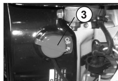
Hebel des Kraftstoffhahns (4) nach rechts schieben.
