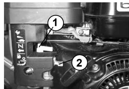
Handgriff (1) des Reversierstarters (2) langsam anziehen, bis Widerstand spürbar wird.
