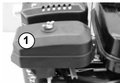
Luftfiltereinsatz (1) aus dem Luftfiltergehäuse entnehmen.
