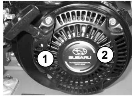
⚠ Nachdem der Motor warm gelaufen ist, Chokehebel nach rechts schieben (öffnen).
