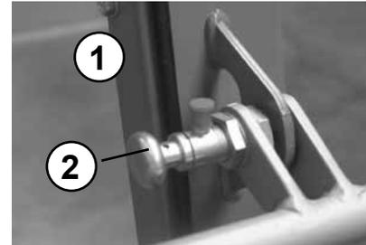
Haltebolzen (1) montieren.
