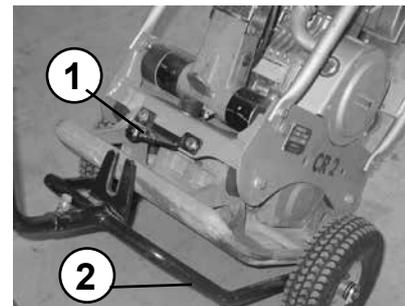
Haltebolzen (1) in das Halteeisen (2) des Fahrwerks einrasten.
