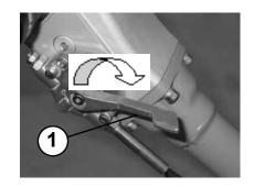
Fahrgeschwindigkeit und Fahrtrichtung mit Handgriff (1) regeln.
