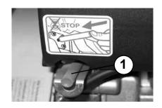
Zündschlüssel bis zur senkrechten Stellung gegen den Uhrzeigersinn drehen.
