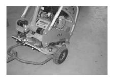
Haltebolzen (1) in das Halteeiesen (2) des Fahrwerks einrasten.
