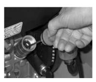
Korrekter Ölstand zwischen min. und max. Markierung.
