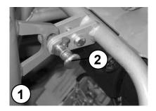
Kranhaken in die klappbare Kranöse (1) einhaken und Maschine auf das gewünschte Transportmittel heben.
