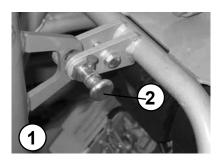
Haltebolzen (1) an die Grundplatte montieren.
