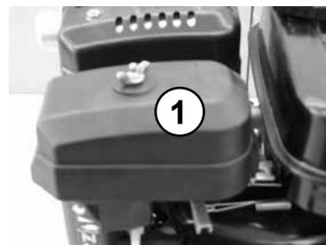
Luftfiltereinsatz (1) aus dem Luftfiltergehäuse entnehmen. Luftfiltereinsatz gem. Vorschrift des Motorenherstellers reinigen, bei Beschädigung oder extremer Verschmutzung austauschen.
