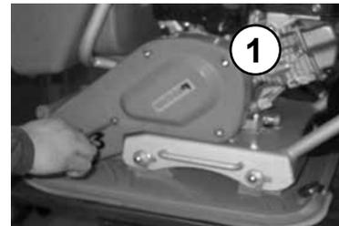
Keilriemen (1) auf Risse, ausgebrochene Flanken sowie Verschleiß prüfen.
