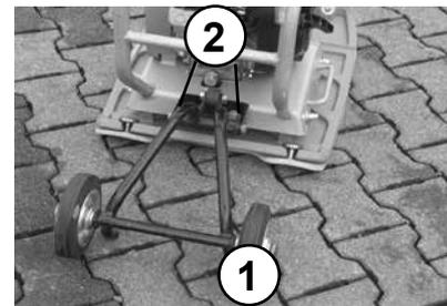
Handführungsstange(1)mit Federriegel (2) arretieren.
