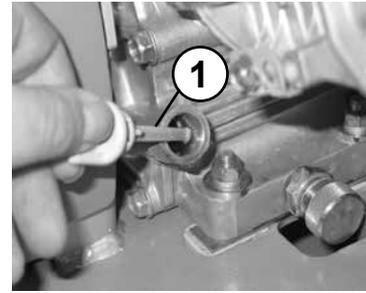
Korrekter Ölstand zwischen min. und max. Markierung.
