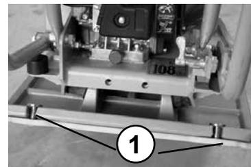
Mit Halter, Schrauben, Federringen und Muttern (1) an der Bodenplatte vorne befestigen.
