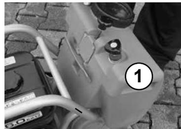
Sterngriffschraube nach unten drücken und Wassertank in den Schutzrahmen montieren.
