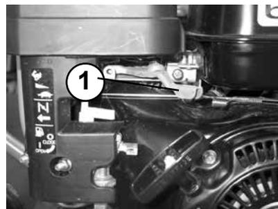
Fahrgeschwindigkeit und Fahrtrichtung mit Handgriff (1) regeln.
