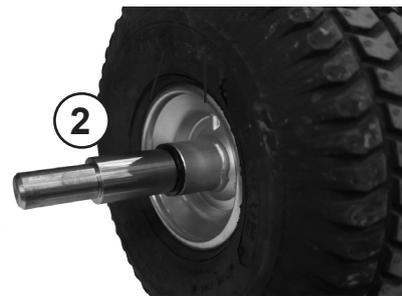
Achsbolzen (3) in die Aufnahmebuchse des Fahrwerks stecken.
