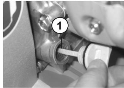
Korrekter Ölstand zwischen min. und max. Markierung.
