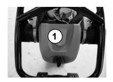
Luftfiltereinsatz aus dem Luftfiltergehäuse entnehmen. Luftfilter (1) reinigen. Luftfiltereinsatz bei Beschädigung oder extremer Verschmutzung austauschen.
