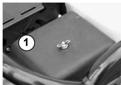
Luftfiltereinsatz (1) aus dem Luftfiltergehäuse entnehmen.
